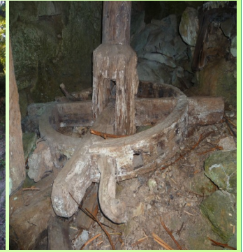
la roue et ses cuillères qui, sous la pression de l'eau, entraînent la meule
