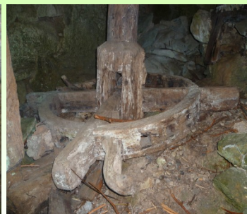
Roue avec cuillères qui sous la pression de l'eau entraînent la meule.
